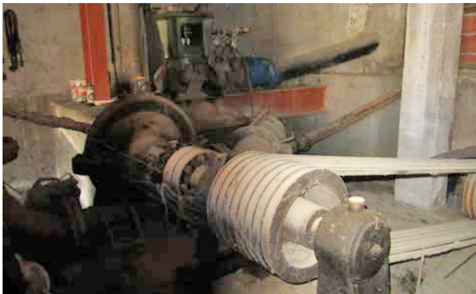
Figura 7. Antiguos motores de la Sociedad «Motor Asunción», para el riego de unas 56 hectáreas en la margen derecha del río Segura (en término de Abarán, fecha de instalación en 1926 y altura de elevación de 60 metros). Fuente: autores (15-03-2023).
